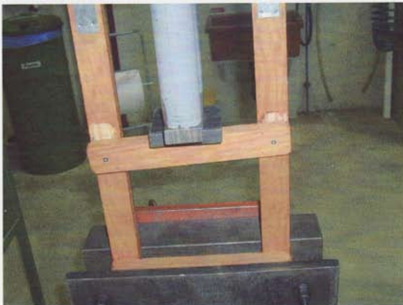
Bild 2: abgescherte Sprosse nach der Belastung mit 6,3 kN
